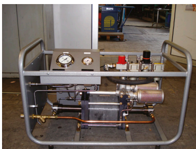
Pompe gros débit S218GJC - jusqu'à 1380 bar
